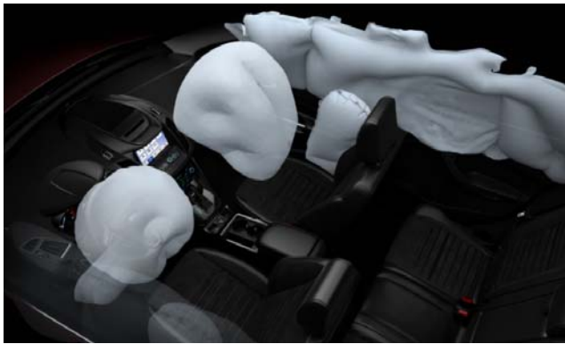
Kuva 1. Esimerkki turvatyynyjärjestelmästä, johon kuuluvat etuistuinten turvatyynyt, kuljettajan polviturvatyyny, turvaverhot ja eturivin sivuturvatyynyt. (Kuva Ford 2017)
